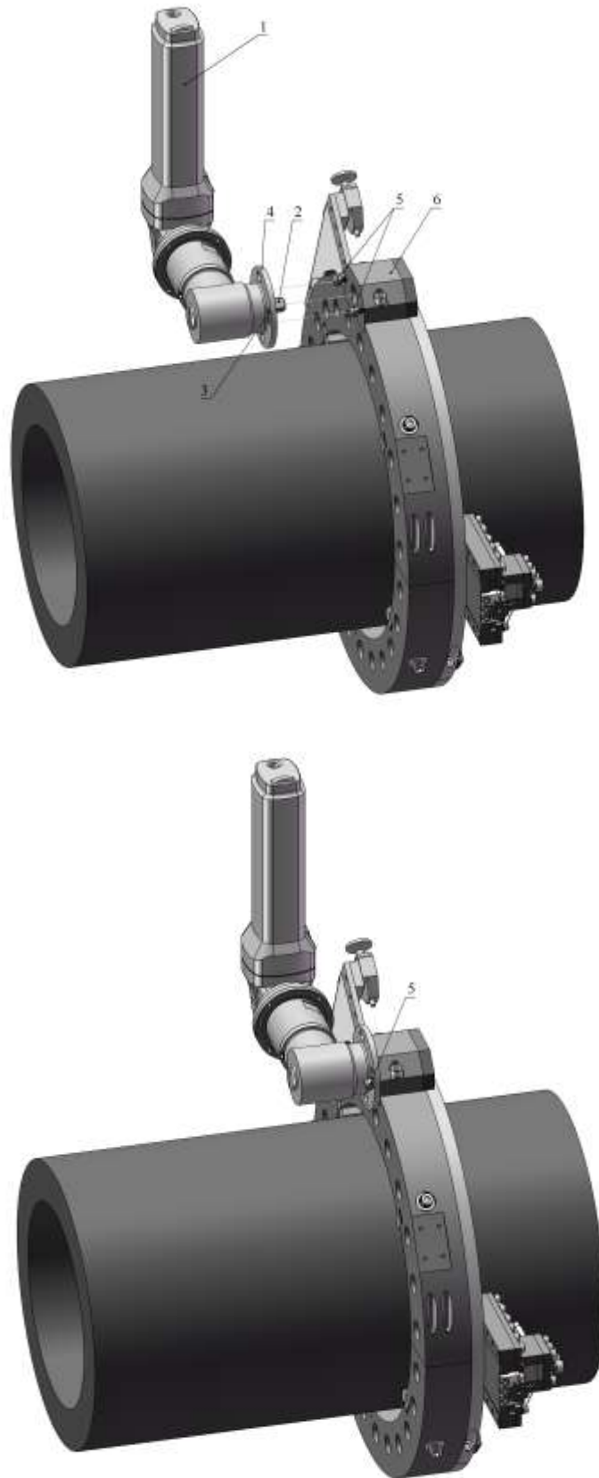
Рис.13. Присоединение электропривода к труборезу
