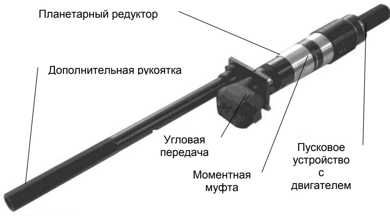
Рис. 1. Общий вид вальцовочной машины К-76-03
